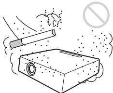
Non installare l'unità in un ambiente molto polveroso o estremamente fumoso. Ciò potrebbe intasare il filtro, causando un malfunzionamento o guasto dell'unità. La polvere che impedisce il passaggio dell'aria attraverso il filtro potrebbe causare un aumento della temperatura interna dell'unità. Pulire periodicamente il filtro.
